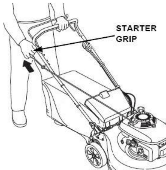
Inmediatamente después del arranque, empuje hacia atrás la palanca del estrangulador de la posición "CHOKE" a la posición "RUN". (Si la temperatura es baja, deje que el motor funcione durante unos minutos antes de comenzar a trabajar).
